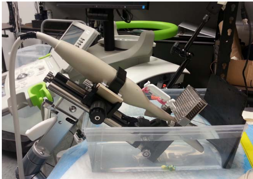
Εικόνα 41: Ηχοβολέας και διαπερινεϊκή βηματική συσκευή στο υδατόλουτρο
